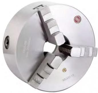
Тип: Патрон 7100-0045 представлен в виде 3-кулачкового, самоцентрирующего устройства. Это означает, что при повороте рукоятки патрона кулачки одновременно движутся к центру или от него с одинаковым усилием, обеспечивая тем самым равномерное и надежное зажимание детали. Самоцентрирующий механизм позволяет значительно ускорить процесс установки заготовок и их последующей обработки, исключая необходимость ручной регулировки каждого кулачка.
